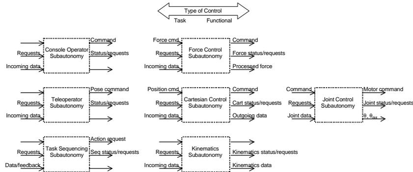
**Fig. 4** Robonaut arm subautonomy layout
