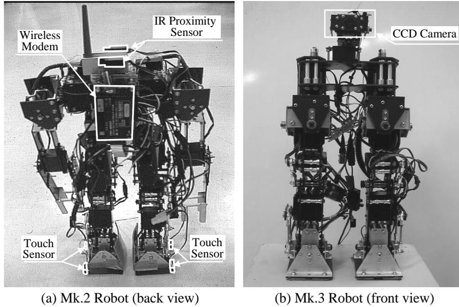
Fig. 6. Mk.2 and Mk.3 Robots
